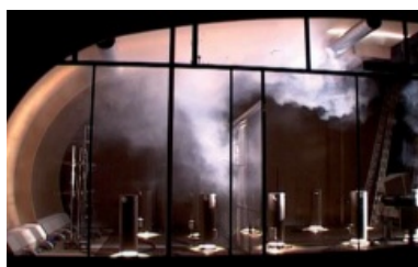
Testy przepływu: pomieszczenie testowe w laboratorium badań i rozwoju firmy TROX
